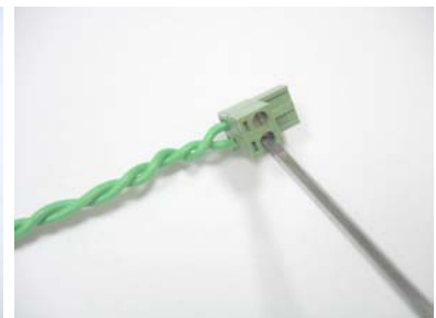
Figure 1.18 - Beide Enden mit einem Schraubendreher fest im Stecker anschließen.
